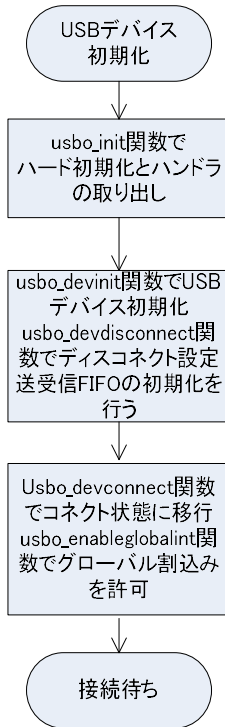
図 4.2.7.3.4 USB デバイスの初期化
